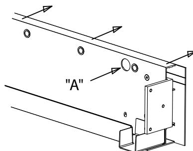
Posizionare i profili portanti sulle pareti preposte (h-H), e fissarli direttamente tramite appropriati tasselli posizionati negli appositi fori "A" (tipo installazione 2.3). Nei tipi d'installazione 2.1 - 2.2 esiste solo un lato fissato a parete.
